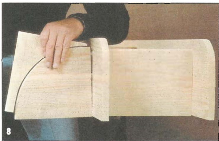
8 Если консоль туго надевается на шканты, по ней можно постучать молотком через обрезок доски.
